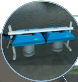
Откачка воды из пруда-хвостохранилища
