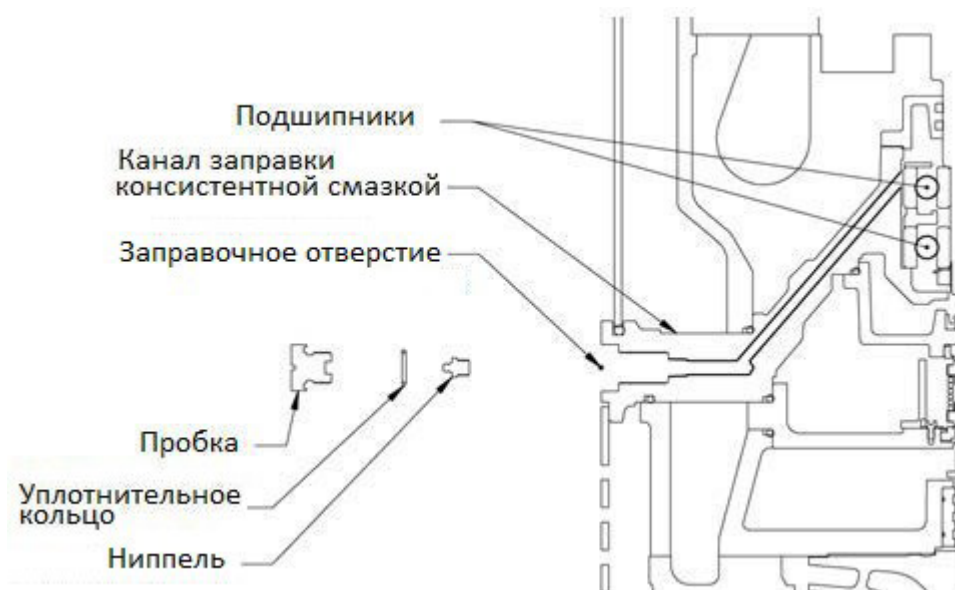
Рис.11 Смазка нижнего подшипника
